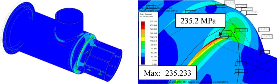
Fig. 4 - von Mises stress - 1<sup>st</sup> case
