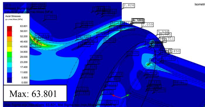
Fig. 5 - von Mises stress - 2<sup>nd</sup> case
