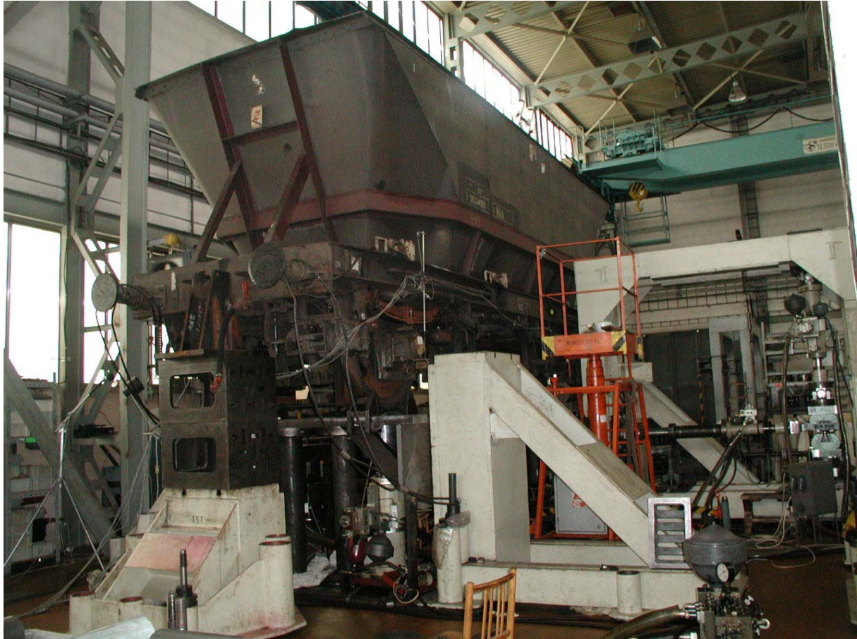
Fig. 1. The MGR Coal Hopper HAA wagon on the test stand in the Dynamic Testing Laboratory ŠKODA VÝZKUM s.r.o.
