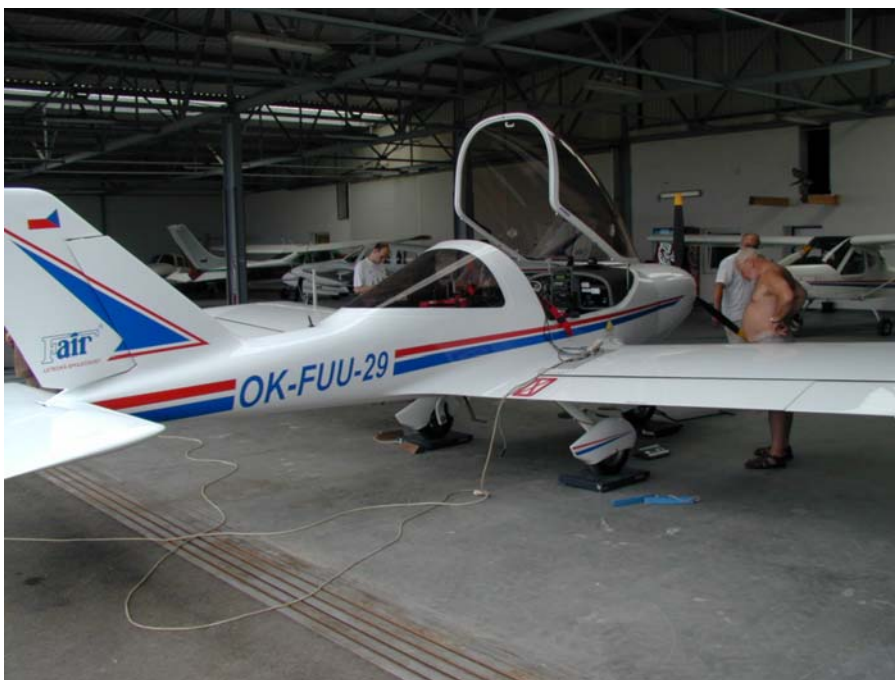
Obr.2 Letoun TL – 96 Star připravený pro měření ohybových momentů
