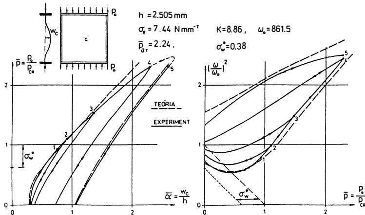
Porovnanie teoretických a experimentálnych frekvencií tenkosteného panelu.
